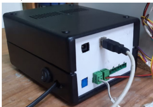
Figura 7: Protótipo da central de monitoramento e controle de \text{CO}_2 .
